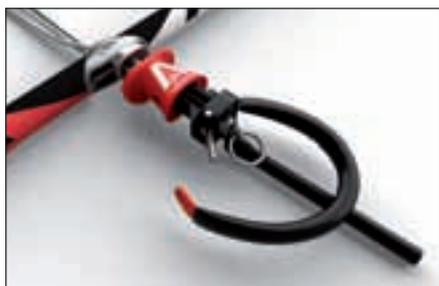
*Beim Auslösemechanismus haben sich die Entwickler von Flysurfer für ein komplett offenes System entschieden. Auf diese Weise wird eindringender Schmutz am leichtesten wieder ausgewaschen, was die Zuverlässigkeit der Funktion erhöht. Das neue System ist zudem besonders leicht und kompakt konstruiert, der Chickenloop beispielsweise wiegt unter 200 Gramm.*
