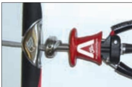
*Eine weitere Innovation ist der neue Wirbel über dem Auslösemechanismus. Mit ihm lassen sich die Leinen nach Rotationen praktisch ohne Kraftaufwand ausdrehen. Hierzu ist einfach die Bar anzuziehen, und schon sind die Leinen wieder frei.*
