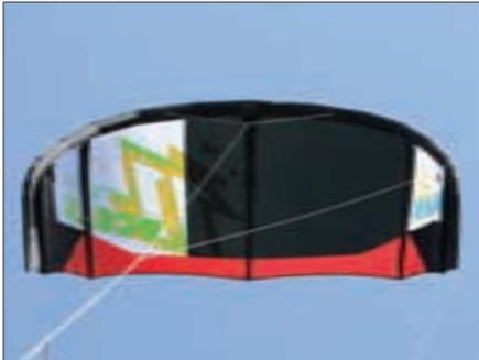
North verbaut exklusiv das reißfestere Tuchmaterial „Technoforce D2“. Es nimmt kein Wasser auf und ist beidseitig mit einer UV-Protektion beschichtet. Die Fünfte Leine wird durch ein „V“ aufgefächert.
