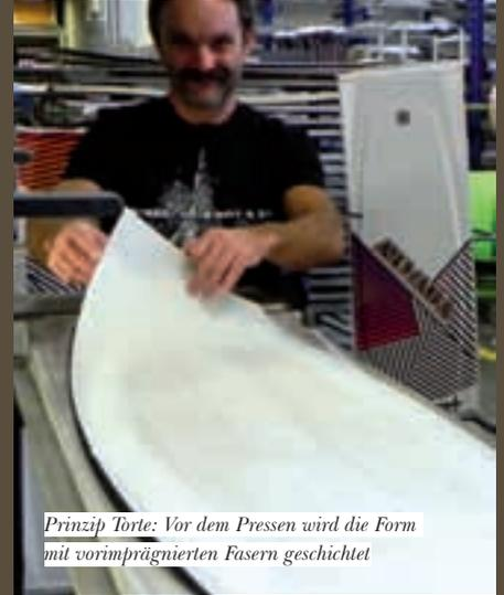
*Prinzip Torte: Vor dem Pressen wird die Form mit vorimprägnierten Fasern geschichtet*
