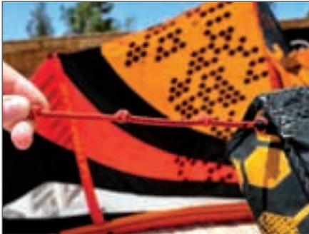
Keine variablen Anknüpfungsoptionen für Steuer- oder Flugleinen an den Tips bedeutet wenig Individualität und keine Verwirrung. Die Steuerleinen können in der Länge verstellt werden.
