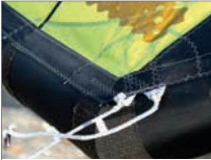
Über die variable Anknüpfung der Flugleinen kann das Bargefühl eingestellt werden. Ganz unten angeknüpft ist die Depower höher, die Barkräfte sind am niedrigsten.
